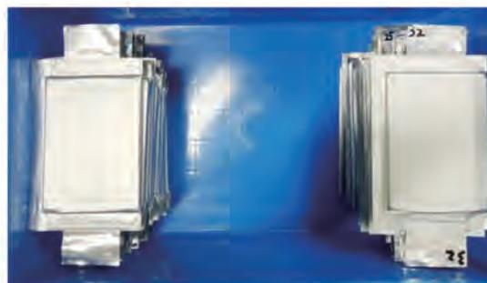
叠片式石墨烯基超级电容器
