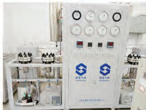
乙醇法制备 1,3- 丁二烯的固定床反应装置
