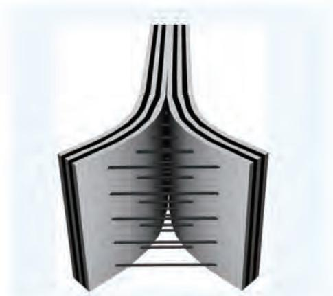
复合材料层间碳纳米管的存在使得综合力学性能显著提高
