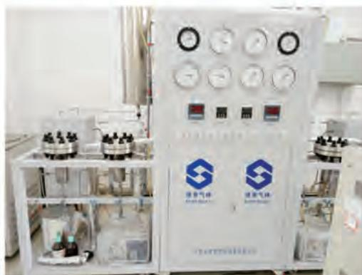
低碳醇耦合制备高碳醇的固定床反应装置
