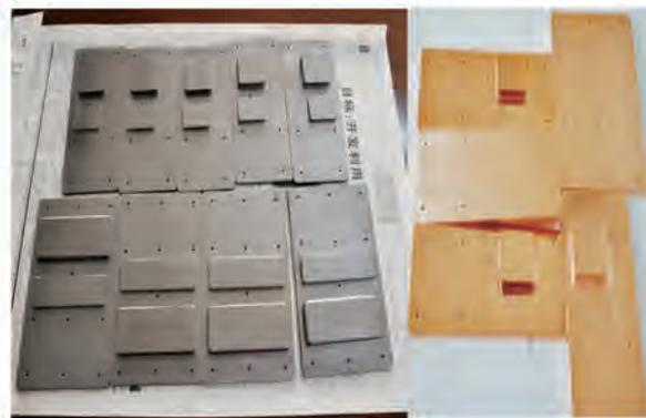
超高导热石墨块体材料（毛坯、机加工后、表面封装后）
