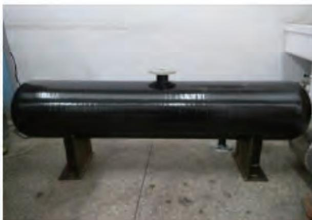
碳纤维复合材料压力容器
