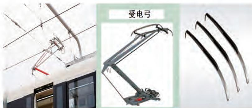
高铁受电弓滑板运行、装置及受电弓滑板材料照片
