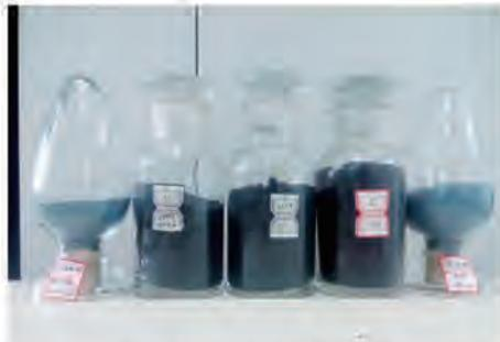
碳化硅基耐高温吸波材料样品
