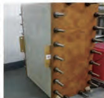
质子交换膜及 5KW 全钒液流电池电堆
